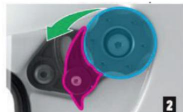
2 - 朝头盔前部,将面罩锁旋转四分之一圈。然后将锁紧凸轮轴从凹槽释放出来。
