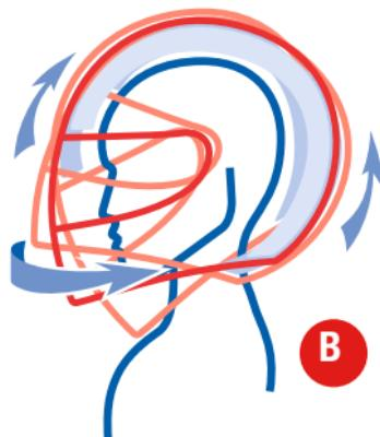
3. con il cinturino allacciato, prendere il casco dalla base posteriore e provare a sfilarlo dalla testa con un movimento rotativo. Provare poi a sfilare il casco prendendolo dalla base della mentoniera. Questi movimenti devono essere fatti in maniera sufficientemente energica. Se il casco inizia a scalzarsi, il casco è troppo grande, provare una taglia più piccola.
