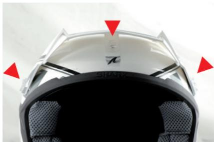
► A. Pour régler votre visière, dévissez les 2 vis latérales (fig.1) et la vis centrale (fig.2).
