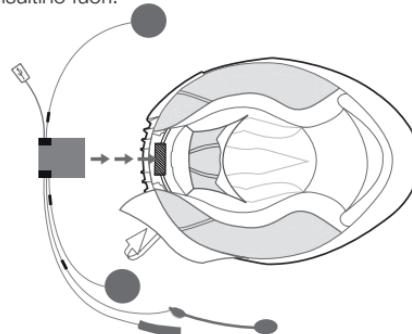
Collegare gli altoparlanti ai due connettori B e C. Fissate entrambi gli altoparlanti nell'apposito alloggiamento. Potete usare il velcro adesivo fornito nella confezione.
