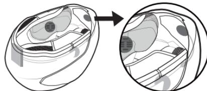
Placer le bouton externe à gauche de votre casque en utilisant l'adhésif 3M déjà dessus. Remettre le rembourrage textile du casque. Cacher le câble de chargement autant que possible sous le rembourrage textile du casque et ne laisser que la prise micro USB pour le rechargement.
