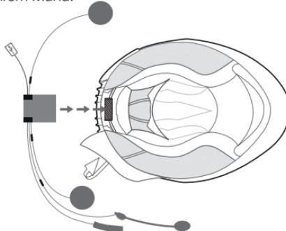
Stecken Sie die zwei Lautsprecher in die Steckvorrichtungen B und C.
