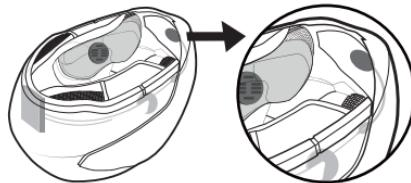
Coloque el botón externo en el lado izquierdo del casco utilizando el adhesivo 3M que ya se encuentra en él.
